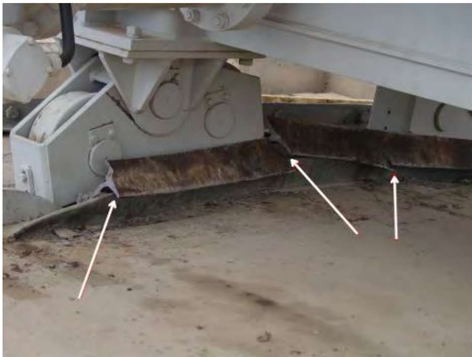
شکل (۶-۲۲): لهیدگی نبشی نشیمن و شکست ریل زیر سری
